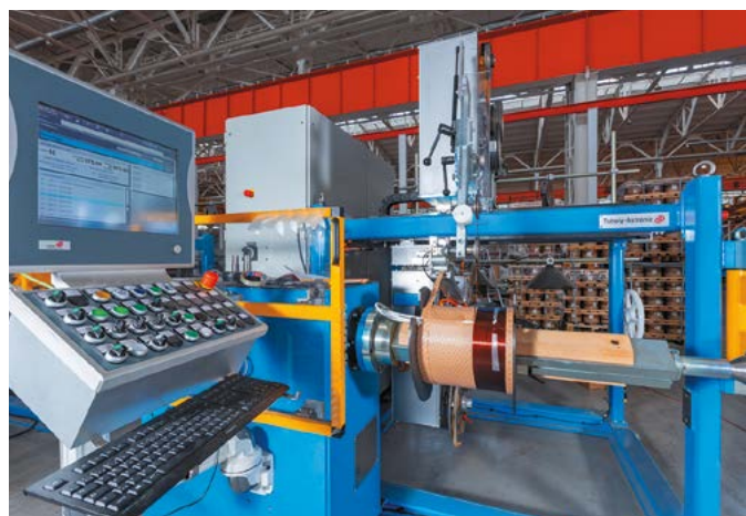
Процесс намотки обмоток ВН
